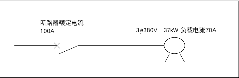
BV导线35mm 2 （允许电流103A）
